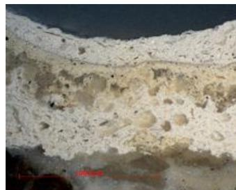
An allen Fassadenabschnitten erstellte Freilegungsfenster sowie Materialuntersuchungen gaben Informationen über die verwendeten Mörtel und dessen Siebkurven.
